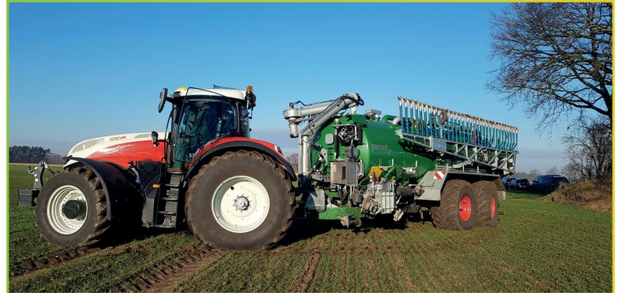
Güllefass der Firma KOTTE mit verbauten M.U.T Sensor
