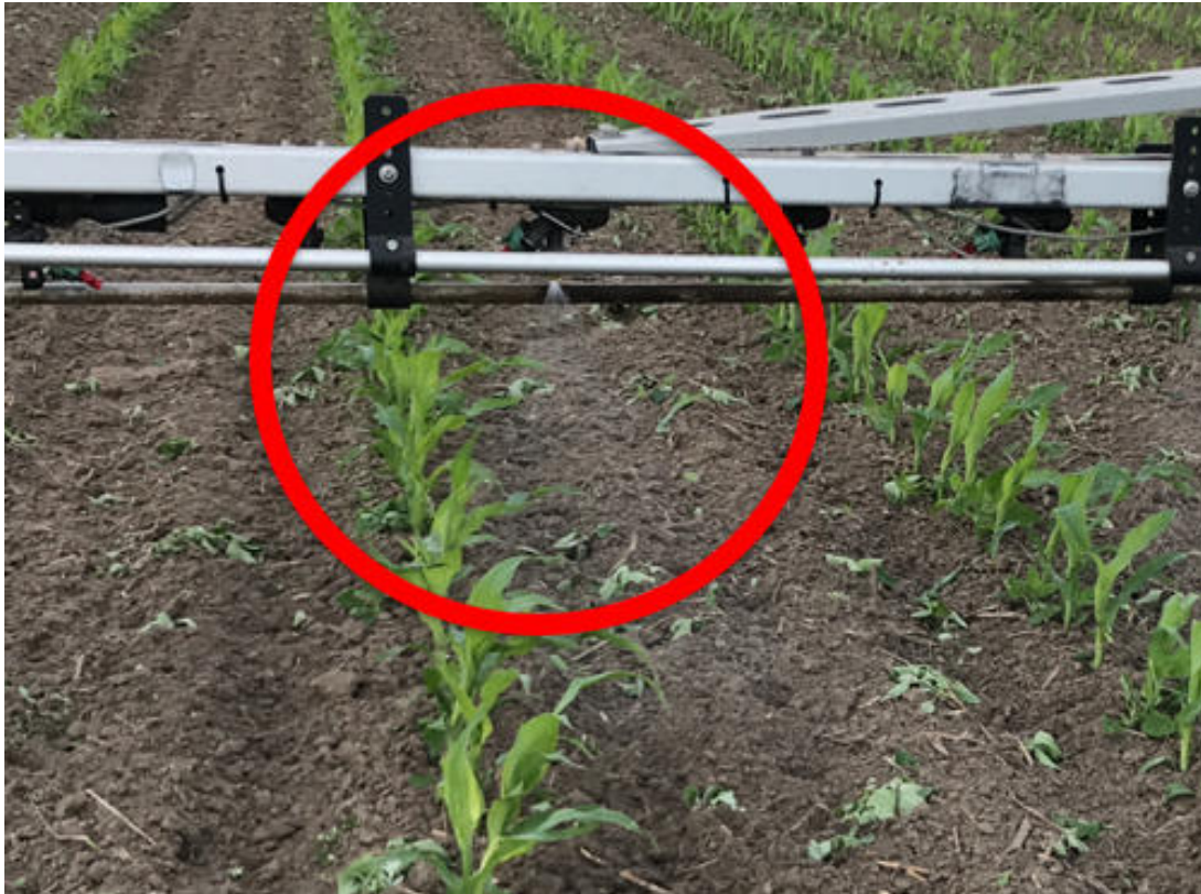
Abbildung 15: Spritzkegel der Bandspritzung im Versuch
