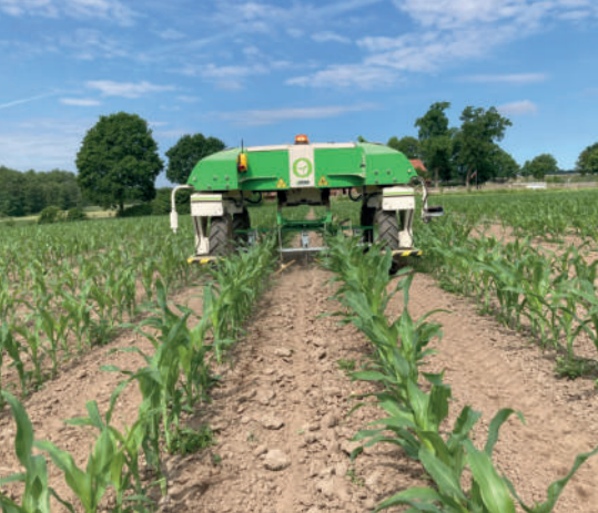
Roboter Dino von Naïo Technologies beim Einsatz im Mais im Experimentierfeld Agro-Nordwest.
