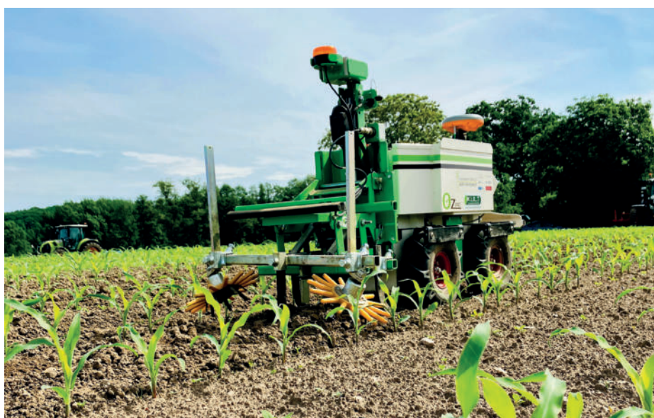
Roboter Oz von Naïo Technologies beim Einsatz im Mais im Experimentierfeld Agro-Nordwest.
