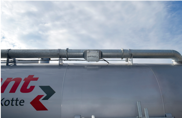
Verbaute NIRS-Technik an waagerechter Druckleitung oberhalb des Fasses
