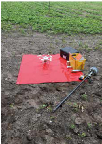
Verwendete Drohnentechnik: DJI Phantom Multispectral mit DRTK 2 Mobil Station von DJI. Fotos: Tobias Jorissen
